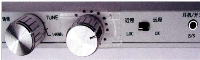
Bild 6: Provisorische Skala am Verstärkungsknopf des RF-2D mit 10-dB-Schritten
