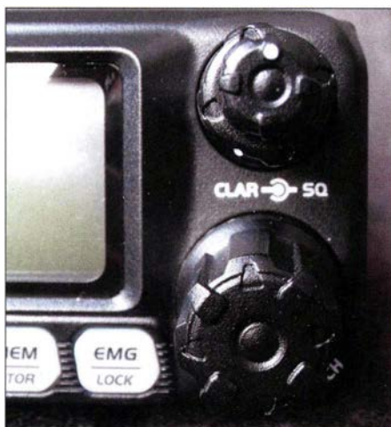
Bild 6: Frontplatte rechts: Doppelpotenzio- meter Clarifier (innen), Squelch (außen) und der Frequenzwahl-Dreheschalter (unten)
