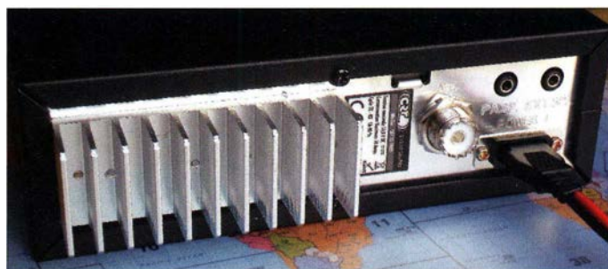
Bild 2: An der Geräterückseite befinden sich Antennenbuchse, 13,8-V-Anschluss, sowie Klinkenbuchsen für externe Lautsprecher.
