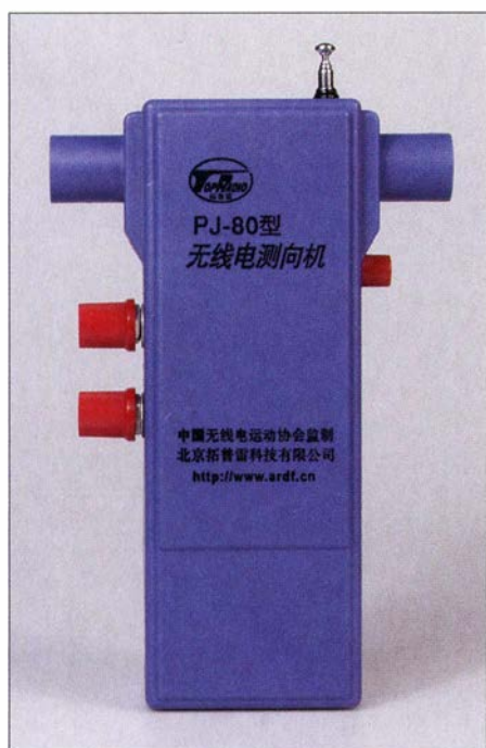
Bild 1: 80-m-Peiler PJ-80 mit Frequenz- und Lautstärkeknopf links sowie dem Taster für die Hilfsantennenumschaltung rechts
