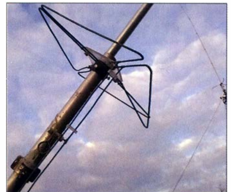
DM0HVL: Das Bild zeigt eindrucksvoll, wie „großformatige“ Vögel die 70-cm-Antenne verbogen haben ... Foto: DL7AIG
