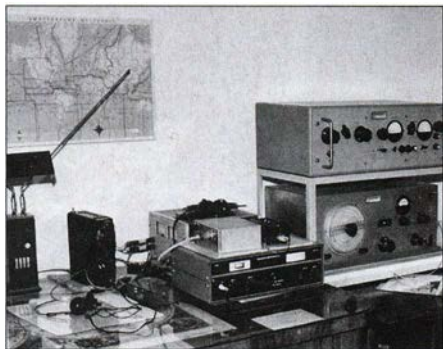
Shack vor 1990, rechts Eigenbau-Transceiver und Endstufe, in der Mitte Empfänger AFE 12
