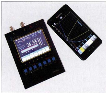
Bild 1: Ansicht des eingeschalteten Antennenanalysators MetroVNA Pro und eines zur externen Steuerung und Anzeige per Bluetooth verbundenen Android-Smartphones
