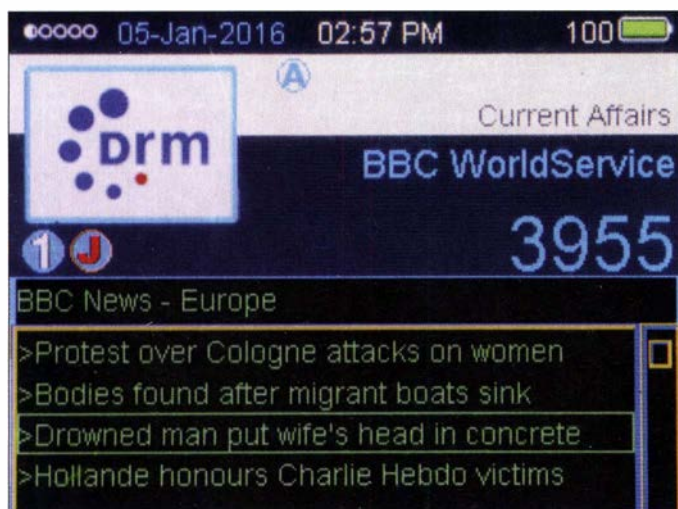
Bild 1: Die BBC überträgt in ihrem DRM-Signal auf 3955 kHz zusätzlich Textnachrichten zur Darstellung auf dem Display eines geeigneten Empfängers, hier der Avion AV-DR-1401.
