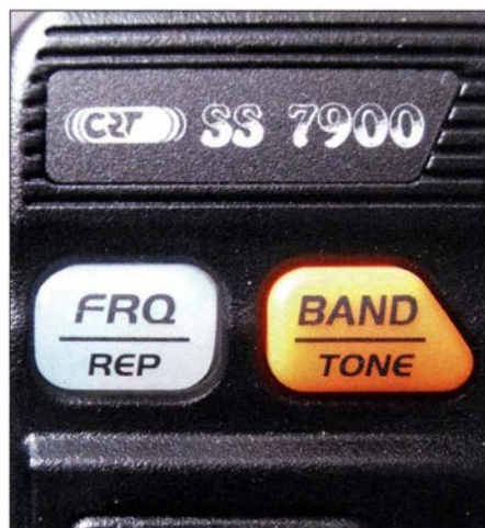
Bild 7: Frontplatte links: Hier die Tasten FRQ und BAND zum Navigieren durch die Bandsegmente A bis I Fotos: DF2BC
