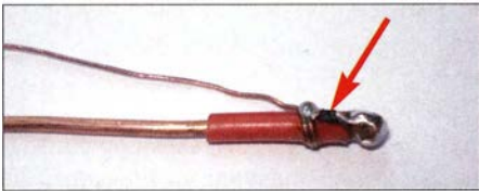
Bild 2: Vorbereitung der Suppressor-Diode
