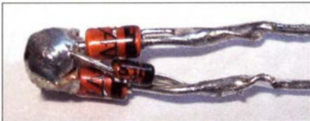
Bild 5: Überspannungsschutz, zusammengesetzt aus vier konventionellen bedrahteten Bauteilen vor dem Einbau ins Steckergehäuse
