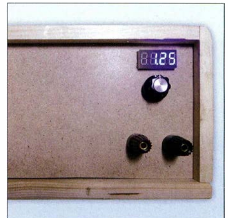
Bild 9: Teil der Frontplatte der variablen Spannungsquelle mit Anzeigemodul, Potenziometerknopf und Ausgangsklemmen
