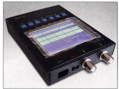
Bild 7: An der schmalen Oberkante sind die beiden BNC-Messbuchsen, die USB-Buchse und der Einschalter angeordnet.
